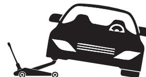
Posicione sempre o macaco sob o eixo ou em uma estrutura plana e reforçada do chassi.
